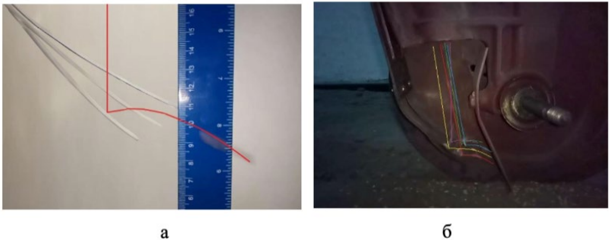
Рис. 4.4. Траєкторія руху, отримана шляхом високошвидкісної відеозйомки: а. Траєкторія руху одиначної зернини; б. Траєкторія руху потоку насіння
