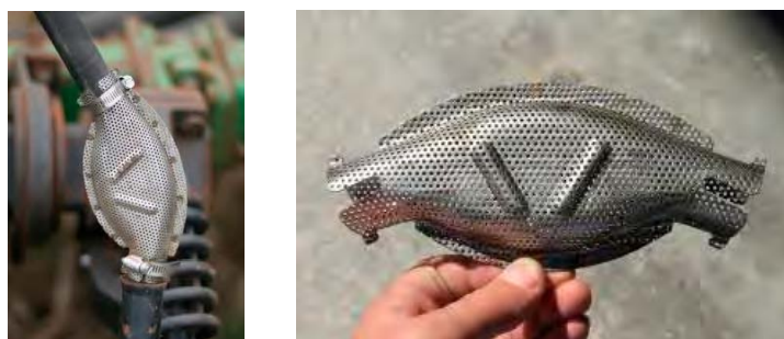
Рисунок 2 – Конструкції сповільнювача насіння
