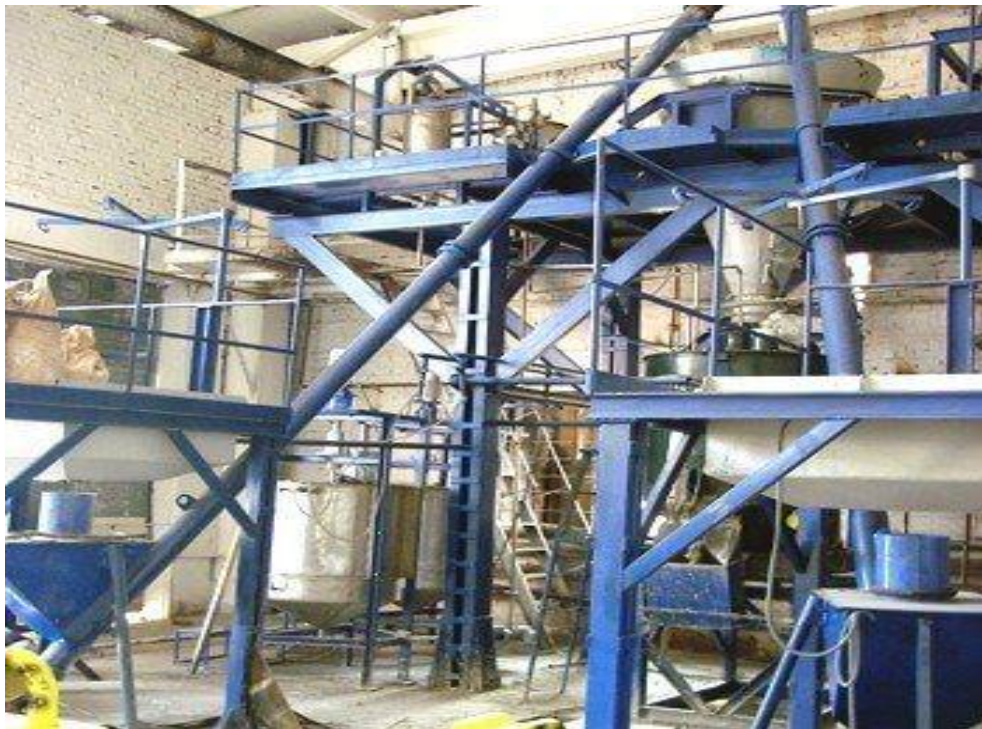
Рис. 3.3. Лінія виробництва газобетону
