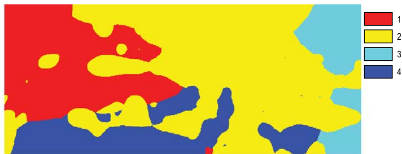
Рис. 64. Ареалы техноземов в пределах экспериментального участка: 1 – лессовидные суглинки; 2 – красно-бурые глины; 3 – насыпной слой чернозема; 4 – серо-зеленые глины
