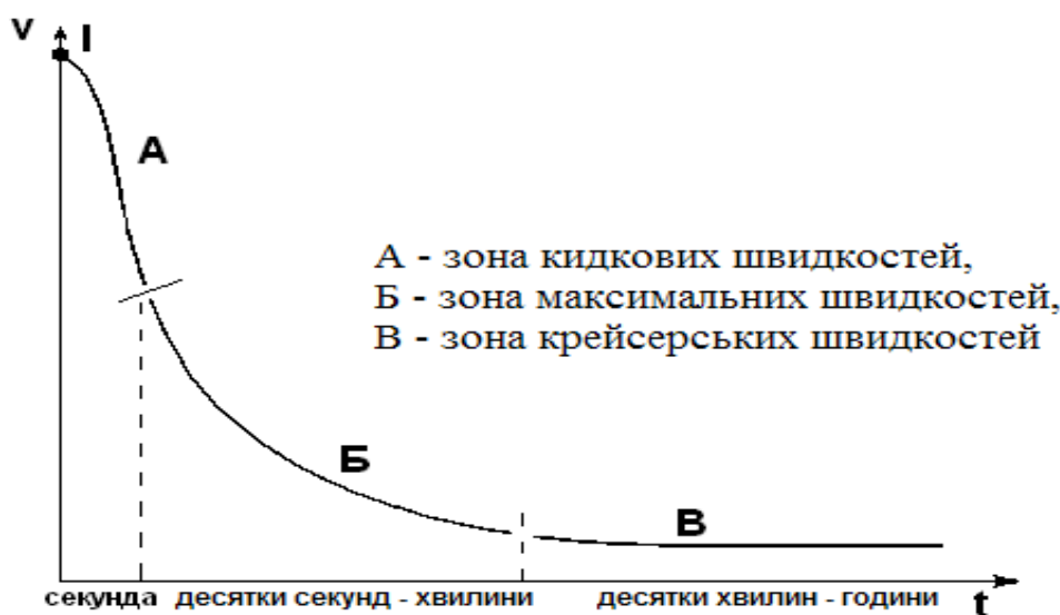
Рис. 6. Схема зміни плавальної здатності риб на різних швидкостях (за Сабуренковим, Павловим, 1968): t – тривалість плавання, V – швидкість плавання, l – максимально доступна швидкість
