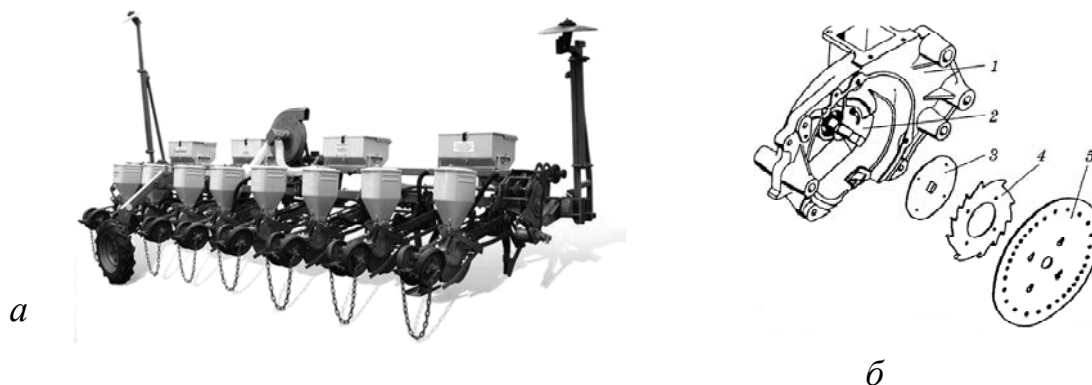
Рис. 4.41. Універсальна пневматична сівалка УПС-8 (а) та її висівний апарат (б): 1 – корпус; 2 – заслінка; 3 – фланець; 4 – ворушилка; 5 – висівний диск
