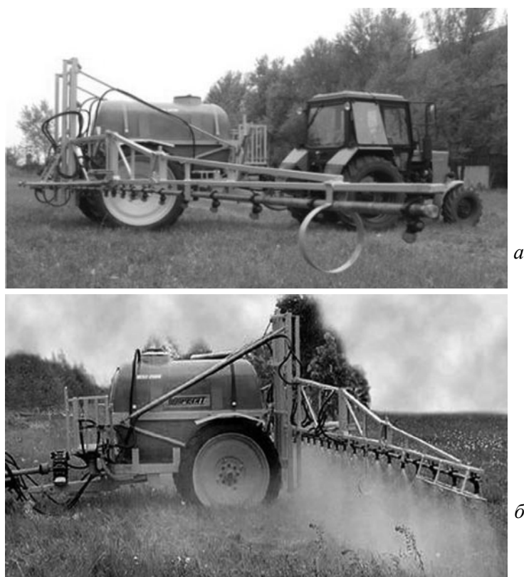
Рис. 4.28. Обприскувач штанговий ОСШ-2500: а – загальний вигляд; б – у процесі роботи
