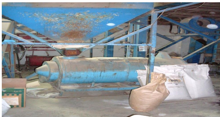
Рис. 2. Обладнання для приготування премікса
