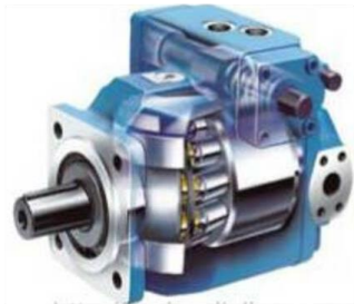
1 – циліндр; 2 – циліндровий блок; – шайба (диск); 4 – розподільний золотник; а і б – серпоподібні вікна
