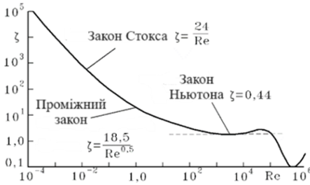
Рисунок 6.2 – Залежність коефіцієнта опору \zeta рідини від критерію Re для руху частинок сферичної форми в рідинах
