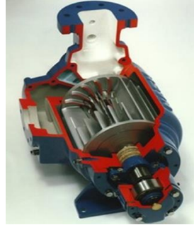
1 – водяне кільце; 2 – нагнітальний отвір; 3 – напірний патрубок; 4 – всмоктувальний патрубок; 5 – корпус; 6 – робоче колесо; 7 – секторний отвір
