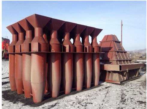
Рисунок 7.12 – Приклади конструкційного виконання батарейних циклонів із зворотно-поточковими елементами з розеточними закручувачами (а) та з напівправликовим входом (б) потоку газу, а також клиноподібними камерами підведення та відведення газів
