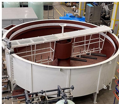
Рисунок 6.5 – Відстійник безперервної дії зі скребковою мішалкою
