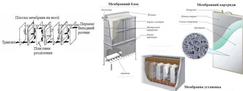
Рисунок 8.9 – Модуль з плоскими мембранними елементами. Схема руху потоків та вигляд установки
