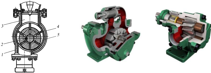
1 – корпус; 2 – ротор; 3 – загрузочная горловина; 4 – пластины; 5 – статор Рисунок 5.19 – Пластинчастий насос. Схема та загальний вигляд з перерізом
