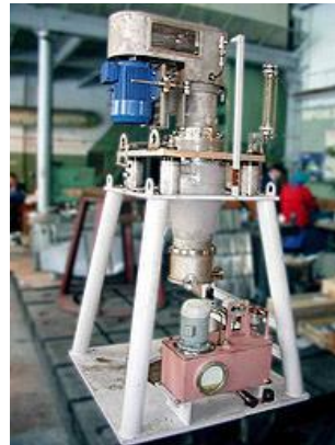
1 – завантажувальний лоток; 2 – запірний конус; 3 – промивна труба; 4 – ротор; 5 – механізм зрізання осаду
