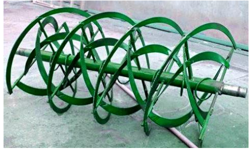
1 – радіальна траверса; 2 – втулка; 3 – вал; 4 та 5 – спіральні стрічки
