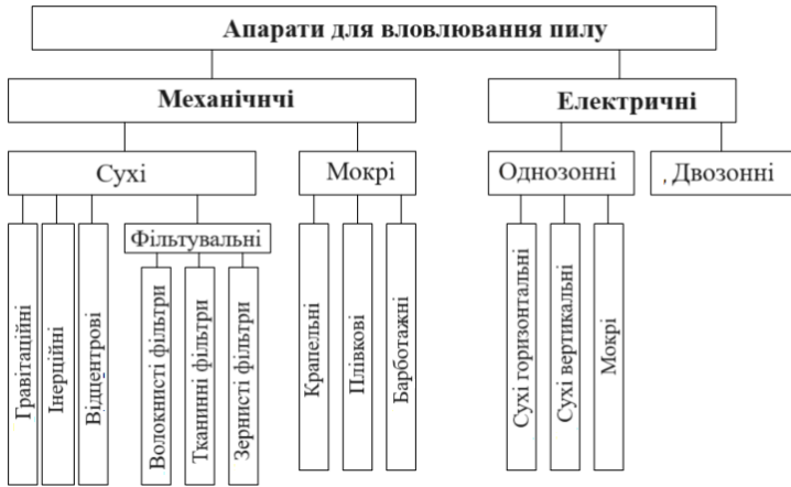
Рисунок 7.1 – Схема класифікації пиловловлювачів
