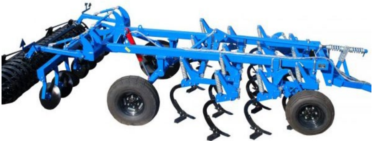
Рис. 2.7. Комбінований ґрунтообробний агрегат АКГ-3 (Уманьферммаш)
