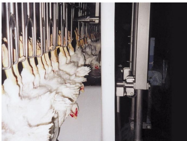
Рисунок 2.2 – Надходження птиці на електрооглушення шляхом занурення птиці у ванну з водою
