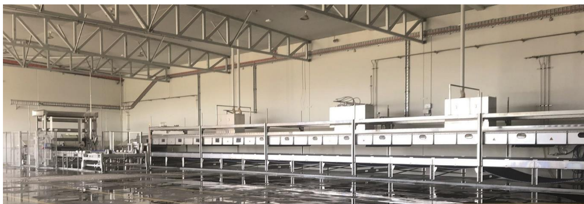
Рисунок 2.10 - Система газового оглушення CAS (Controlled Atmosphere Stunning)
