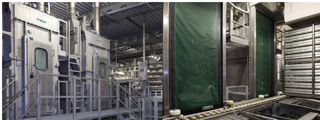
Рисунок 2.11 - Система газового оглушення Stork (Meun)
