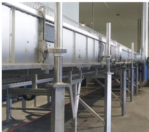
Рисунок 2.9 - Система газового оглушення Butina
