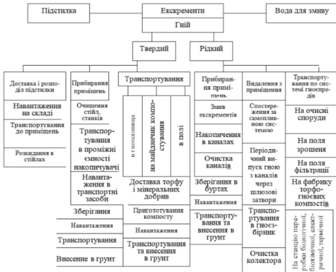
Рис.1.2 - Варіації класичних технологічних схем, очищення, зберігання та утилізації гною та фермах.
