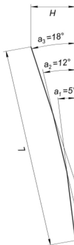
Рис. 3.4 Обрана форма ріжучого органу копача
