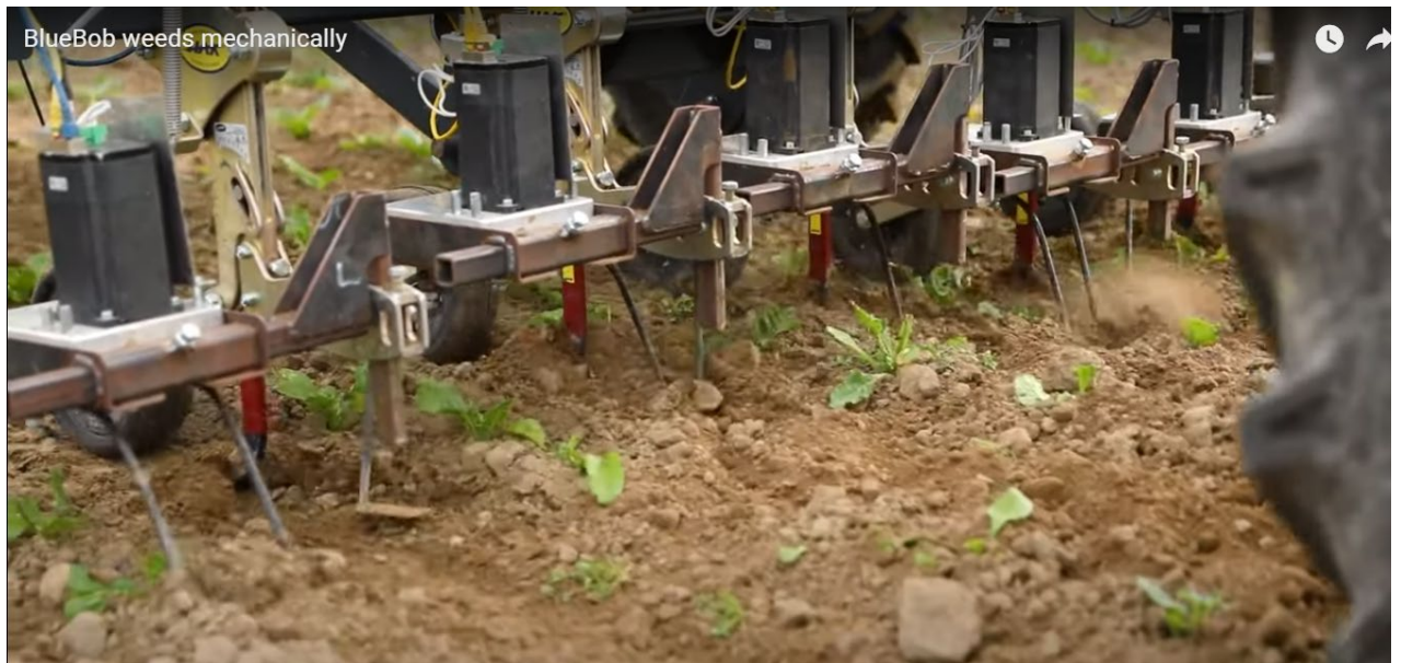
Рис. 2.4. Загальний вигляд активних робочих органів мотик агроробота
