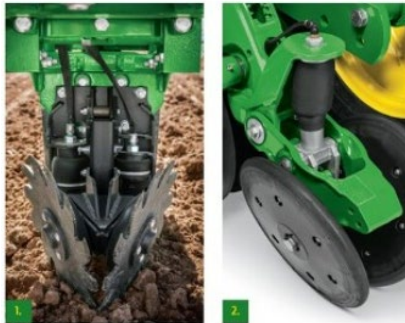
Рисунок 1.8 – Конструкції прикочуючих механізмів з різними типами коліс (дисків) [15]
