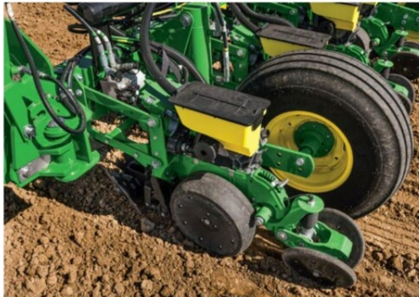
Рисунок 1.7 – Посівні секції сівалок виробництва John Deere із різними конструкціями механізмів копіювання [15]
