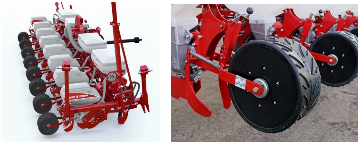
Рис. 1.12 – Сівалка Vesta 8 Profi та її механізм прикочування
