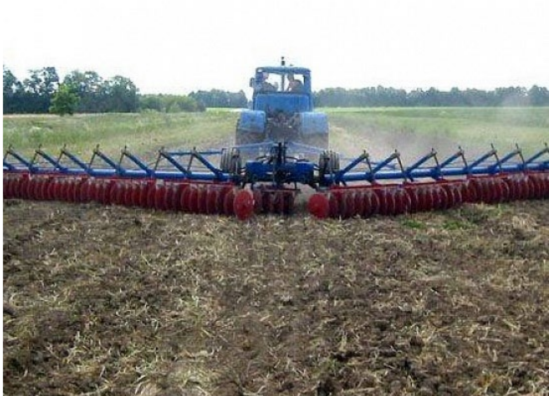
Рисунок 2.1 – Луцильник дисковий гідрофікований ЛДГ-15.
