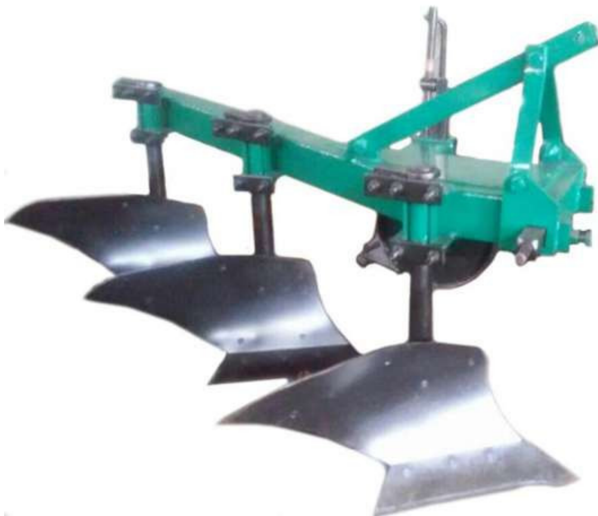
Рисунок 2.3 – Плуг навісний ярусний ПНЯ-4-42 ОАПК.
