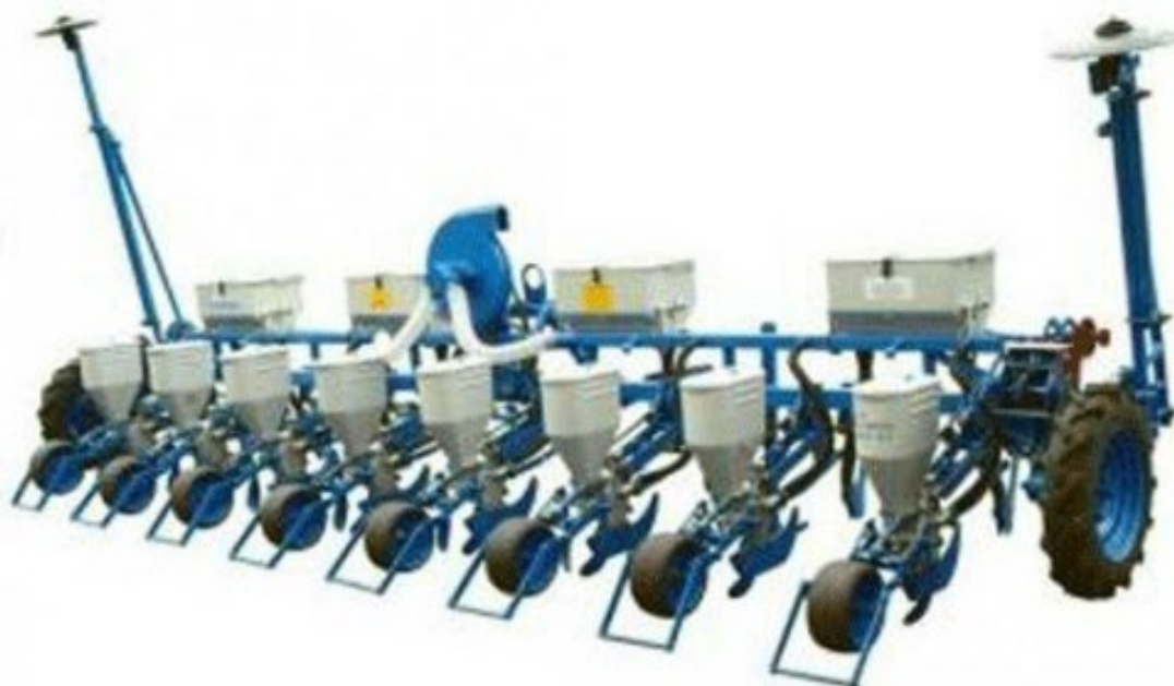
Рисунок 2.5 – Сівалка універсальна пневматична СУПН-8А.
