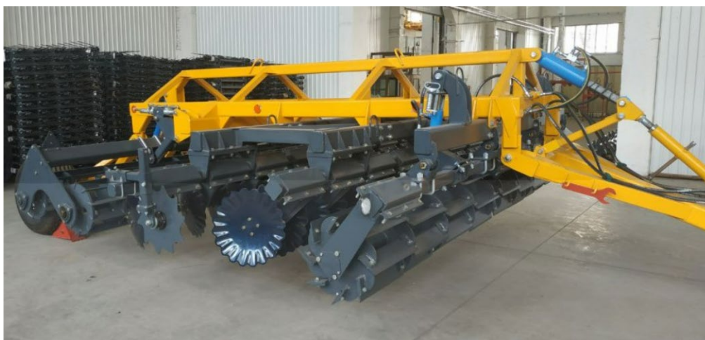
Рисунок 1.9 – Дискатор комбінований ДК-4000 [15]
