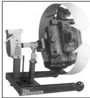
Рис 2.5-Стенд для ремонту двигуна Revolver-OEM4137
