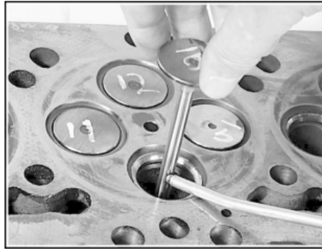
Рис 4.8-Перевірка штоку клапана
