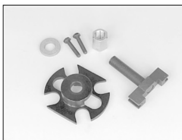
Рис 2.9-Компресор пружини клапана 3164321(Cummins)
