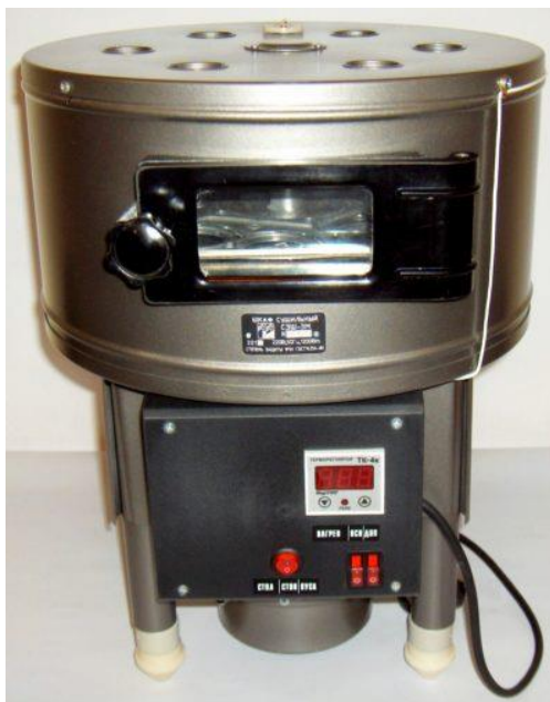
Рисунок 2.13 – Сушильна шафа СЕШ-3М
