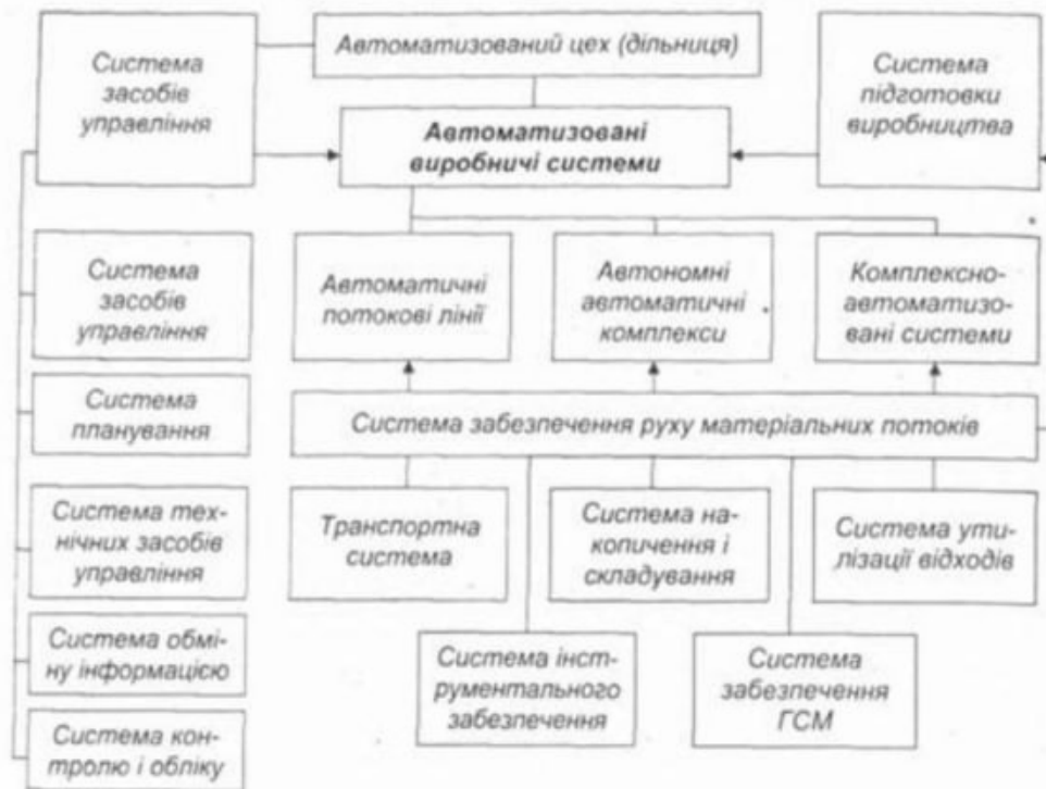
Рисунок 3.1.3 Структура і схема автоматизації процесів[1;2;3;4;5;6;7;8;9;10]
