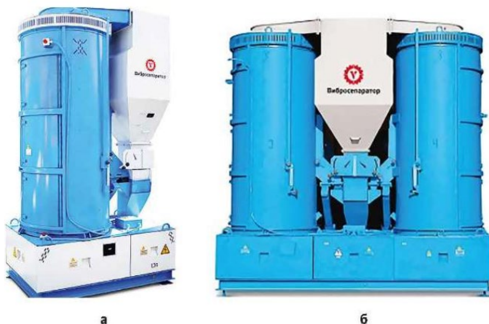
Рисунок 3.1.1 Сепаратори вібровідцентрові зернові БЦС-25 (а) та БЦС-50 (б)[13]
