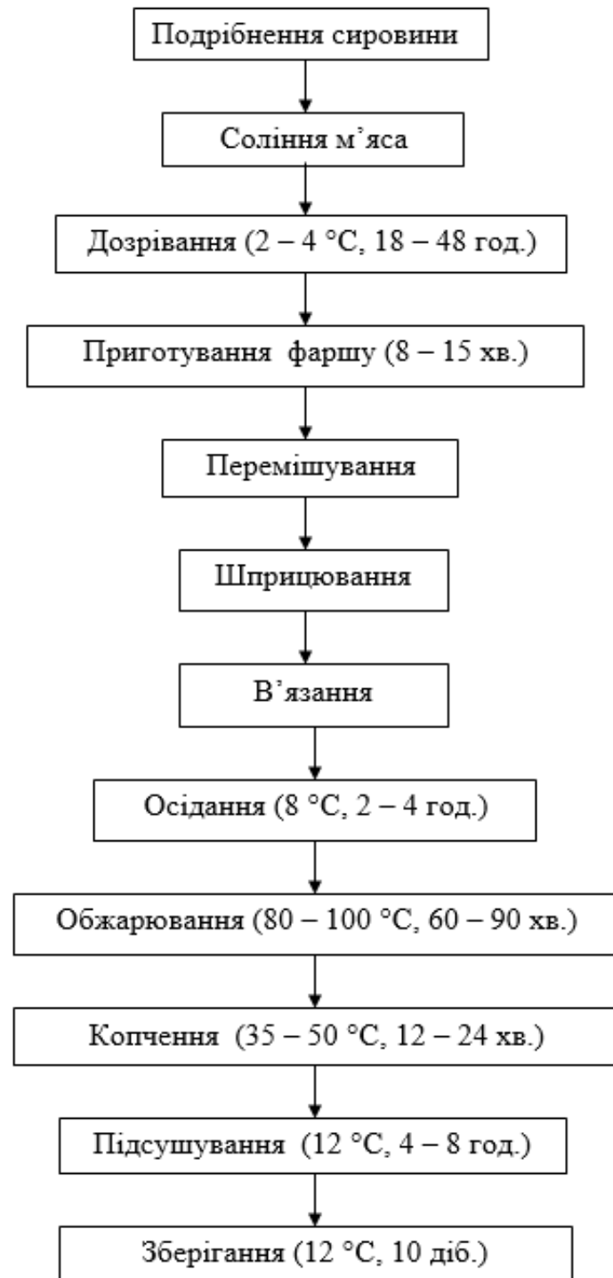
Рисунок 1.3 – Технологічна схема виробництва напівкопчених ковбас
