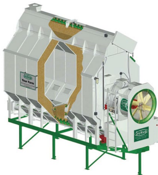
Рисунок 2.4 – Принципова схема зерносушарки Sukup (США)
