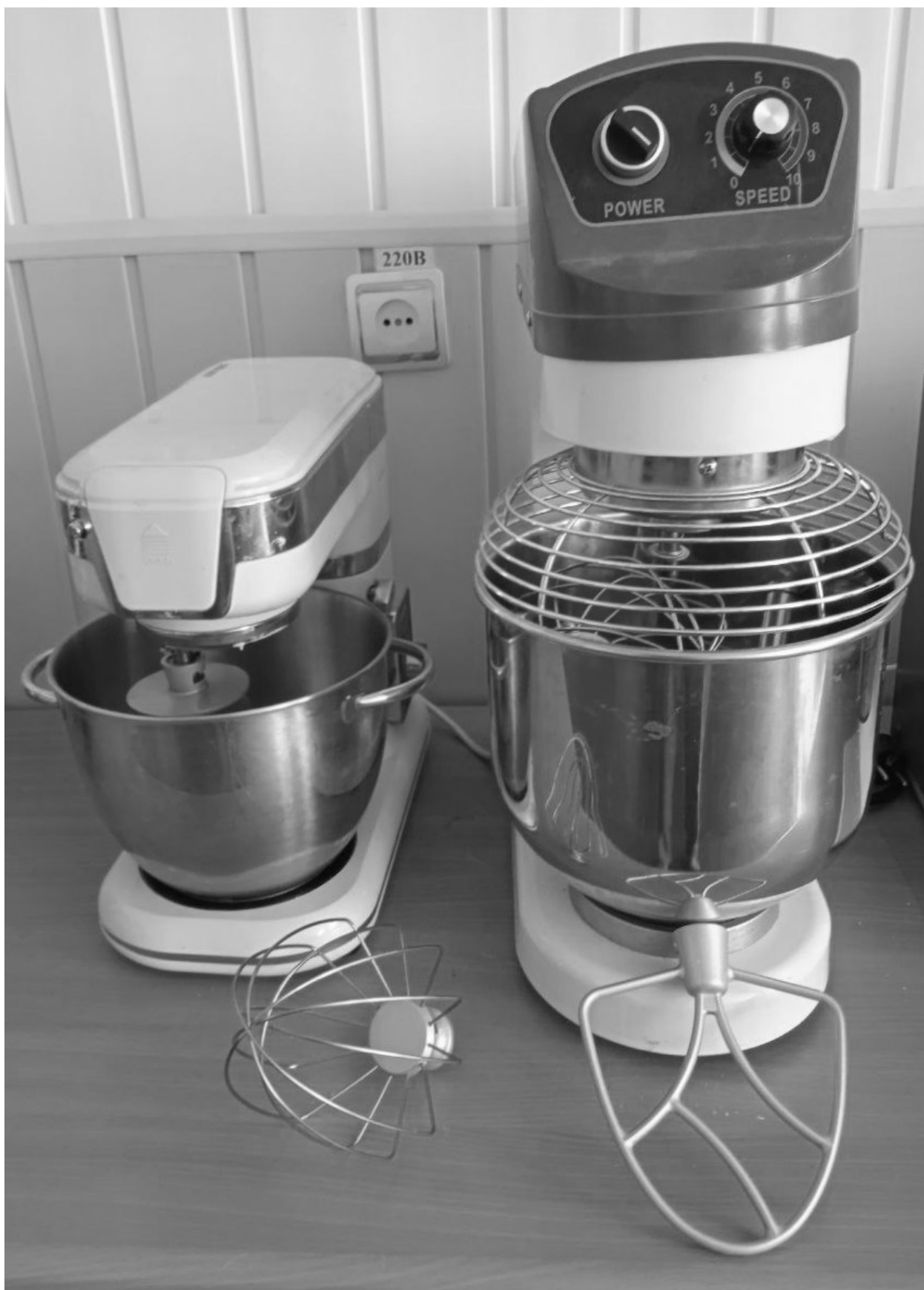
Рис. 2.9. Лабораторна тістомісильна машина з двома видами місильних робочих органів: зліва-прутьний, з права-решітчастий.
