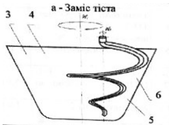
Рис. 2.12. Спіральний місильний робочий орган тістомісильної машини.
