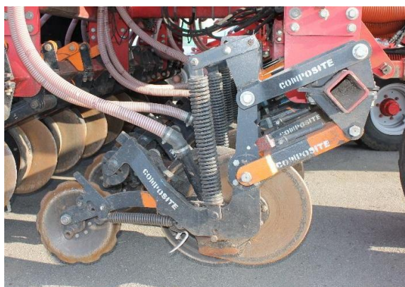
Рисунок 3.14 – Секція посівного комплексу Агро-Союз Turbosem II 19-60, механізм копіювання якого укомплектований деталями з ПКМ
