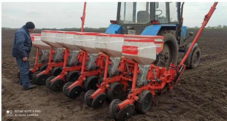
Рисунок 3.6 – МТА для сівби, з модернізованою ПКМ, сівалкою Maschio Gaspardo МТ
