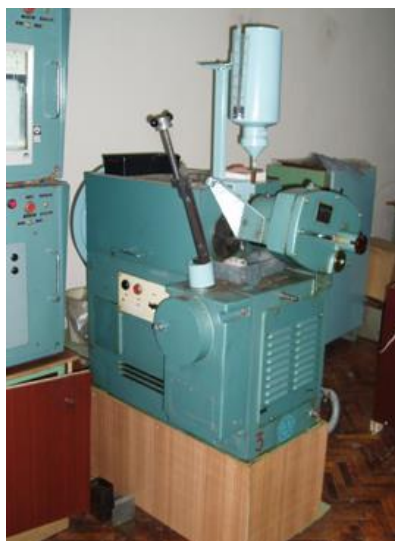
Рисунок 2.8 – Машина тертя СМЦ-2 (а) та схема реалізації процесу абразивного зношування (б): 1 – гумовий ролик; 2 – абразивний матеріал; 3 – механізм створення навантаження; 4 – зразок матеріалу, що досліджується
