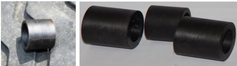
Рисунок 3.11 – Експериментальні деталі, виготовлені з ПКМ УПА-6-20М, з додаванням 5 % ВП LDPE
