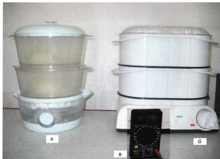
Рисунок 2.2 – Встановлення для дослідження термічної обробки тістових заготовок в атмосфері насиченої пари
