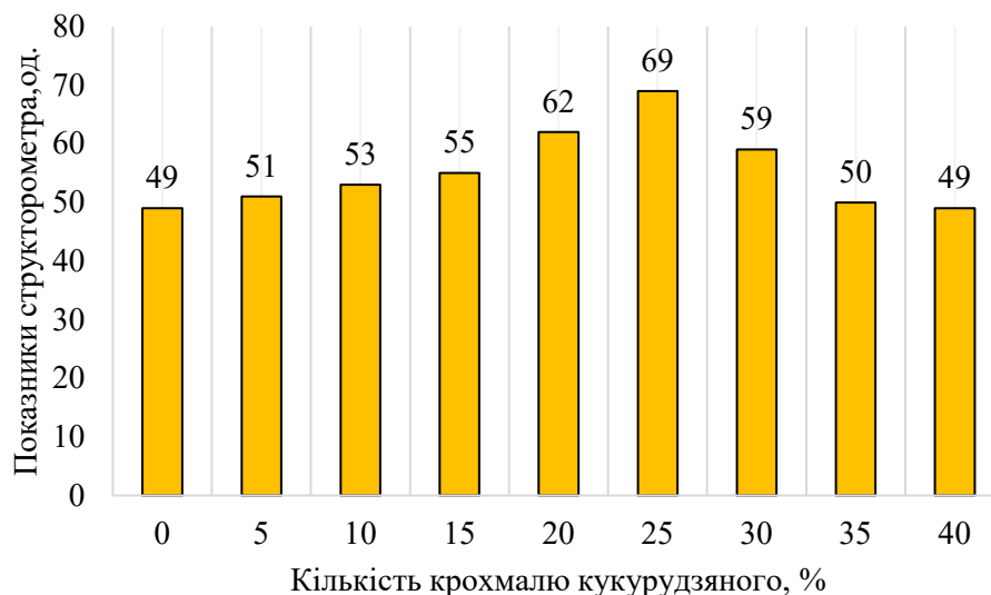
Рисунок 3.4 – Залежність структурних властивостей цукрової глазури кількості крохмалю кукурудзяного (в % до маси цукрової пудри)
