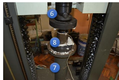
Рис. 2. Схема (а) та загальний вигляд (б) випробувальної машини Heckert FP-100/1 з додатковим обладнанням: 1 – аналогово-цифровий перетворювач NI USB-6008; 2 – ПЕОМ; 3 – силовімірник; 4 – панель налаштувань FP-100/1; 5 – панель керування FP-100/1; 6 – рухома траверса; 7 – нерухома траверса; 8 – прес-форма з досліджуваним зразком; 9 – цифровий термометр з термопарою FLUS ET-960; 10 – лабораторний автотрансформатор ЛАТР-1М
