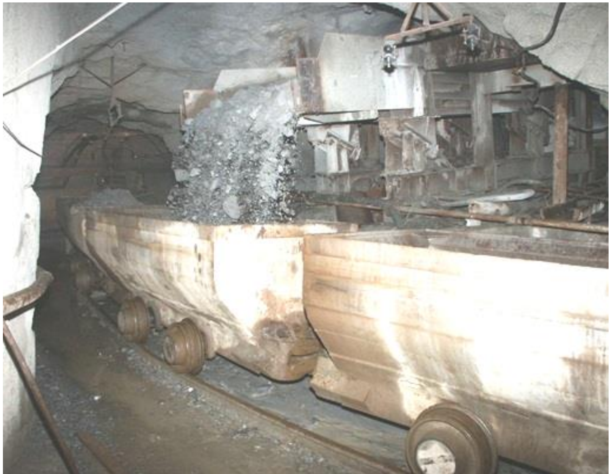
Рис. 1. Випуск уранової руди віброживильником ВІР-4М
