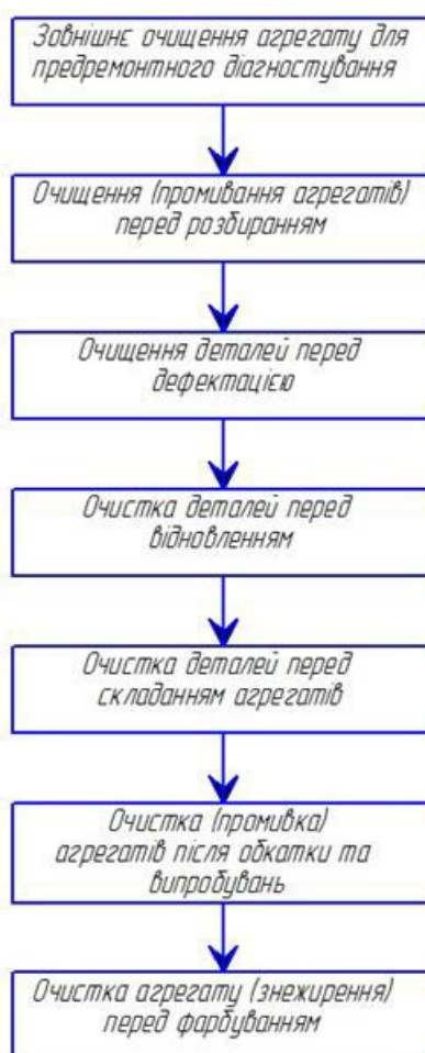
Рисунок 2. Рекомендована схема операцій багатостадійної очистки в технологічному процесі ремонту гідравлічних агрегатів
