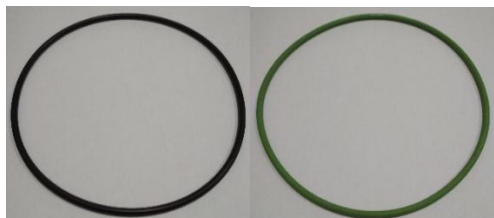
Рис. 1 Досліджувані ущільнювальні кільця типу O-ring: чорного кольору- оригінальне; зеленого – аналог.
