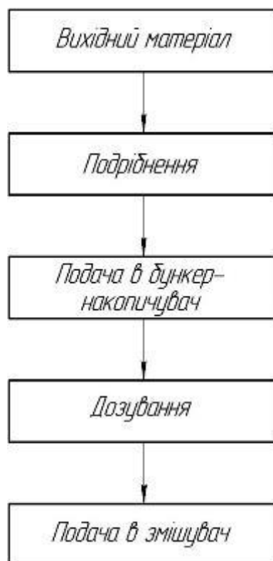
Рисунок 2.1 – Технологічна схема підготовки концентрованих кормів
