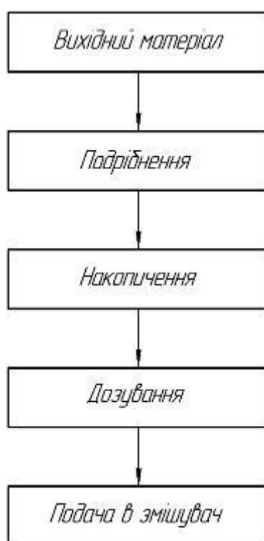
Рисунок 2.4 – Технологічна схема підготовки сінної муки
