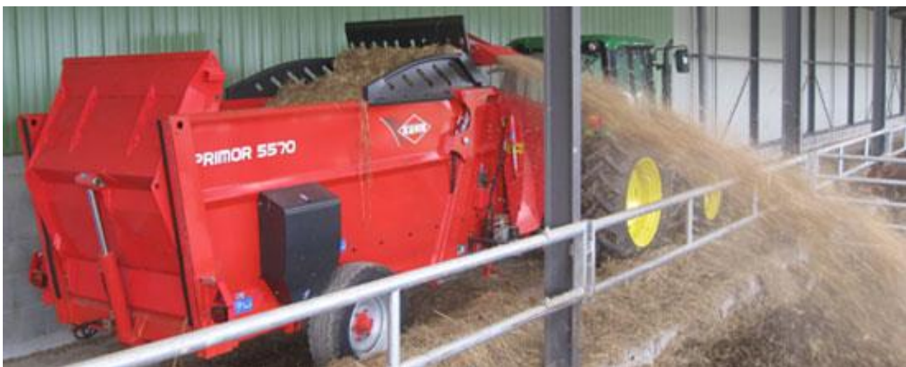
Рисунок 3.1 – Внесення солом'яної підстилки кормороздвачем-змішувачем SILOKING (а) і тюковозом-подрібнювачем PRIMOR 5570 М (б)
