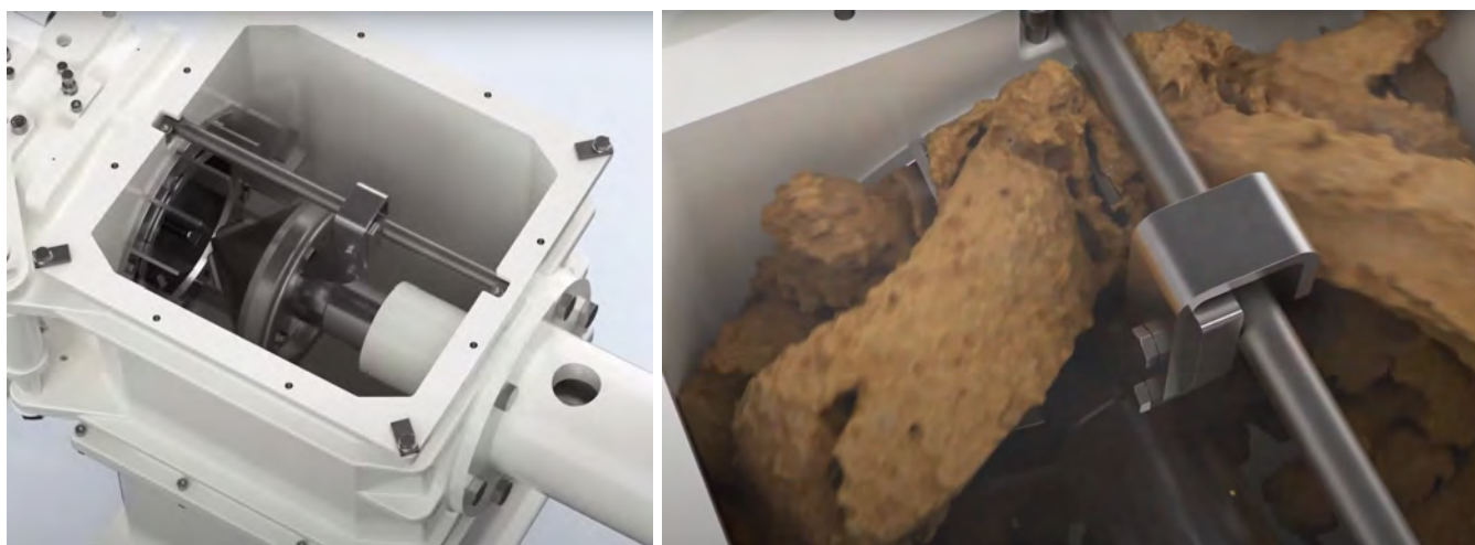
Рисунок 1.14 – Запираючий конус експандера серії OE фірми Amandus Kahl
