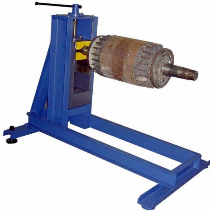
Рис. 3.6. Стенд ЦАЕИ 04.03.36 для складання ротора зі статором Саме цей стенд приймемо за прототип.
