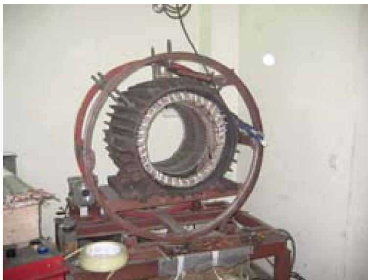
Рис. 3.1. Пристосування для повороту ротора чи статора електродвигуна УПС1
