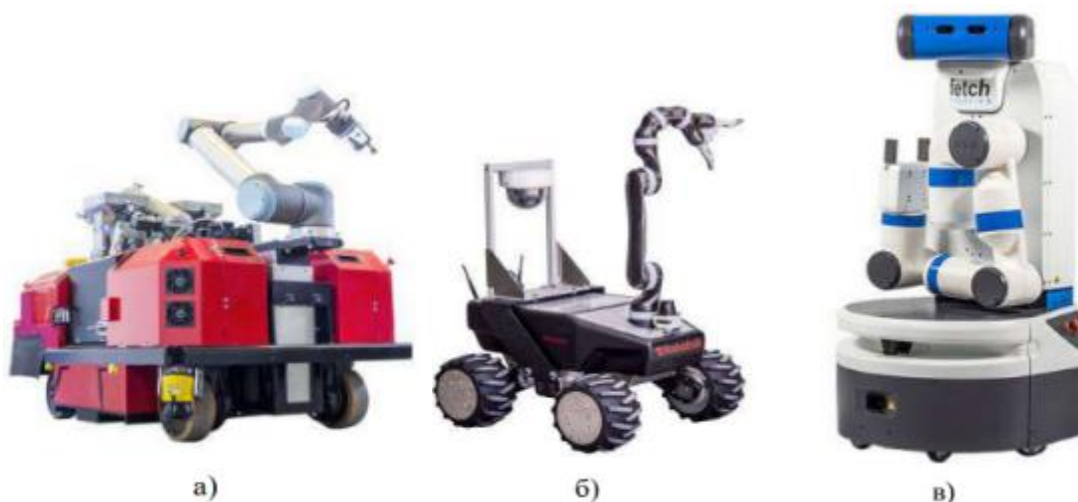
Рисунок 2.12 – Мобільні роботи маніпулятори ROBOTNIK AUTOMATION: а – RB-VULCANO; б – XL-GEN; в – FETCH
