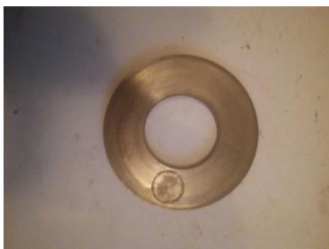
Рис 4.2 – Корозійний знос люльки
