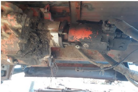
Зовнішня забрудненість аксіально-поршневого гідромотора
