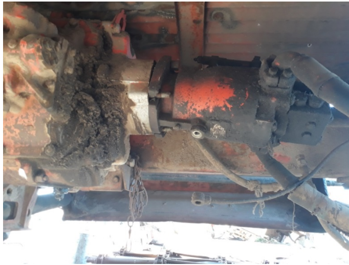
Рисунок 1.3 – Зовнішня забрудненість аксіально-поршневого гідромотора
