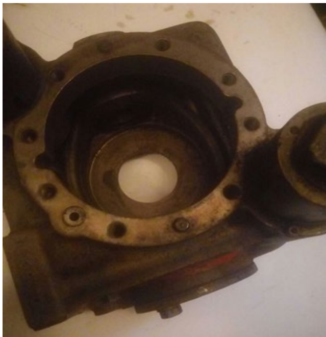
Рисунок 1.5 – Залишки промасленого пилу в картері гідронасоса
