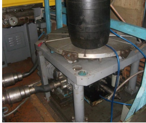
Рис. 3.5 – Установка з просторовим вібраційним навантаженням
