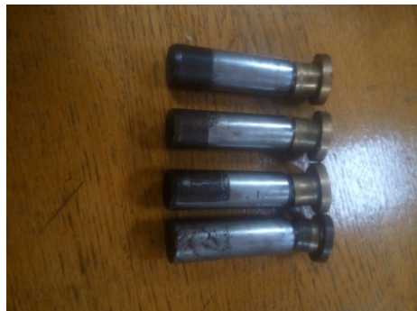
Рис. 4.1 – Корозійний знос плунжерів
