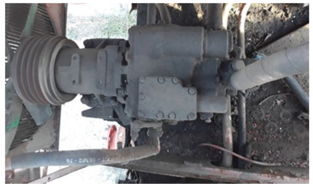
Зовнішня забрудненість аксіально- поршневого гідронасоса.
