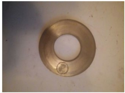
Корозійний знос опори люльки
