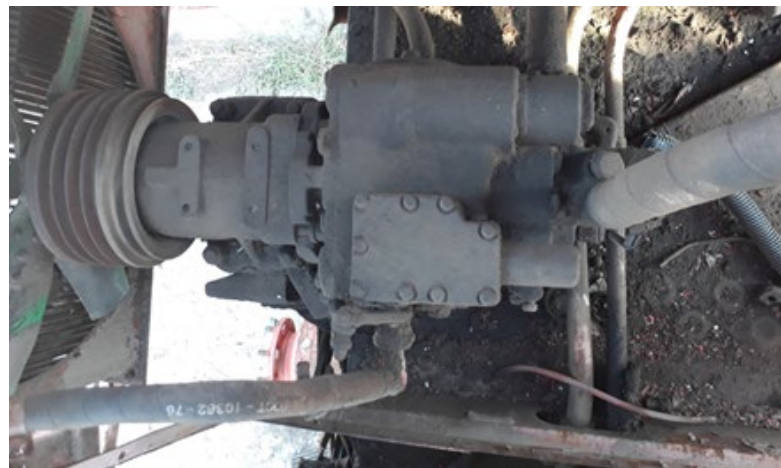
Рисунок 1.4 – Зовнішня забрудненість аксіально-поршневого гідронасоса.
