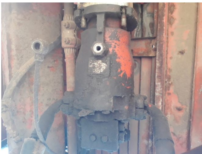
Рисунок 1.6 – Зберігання розгерметизованого гідромотора з дренажним отвором
