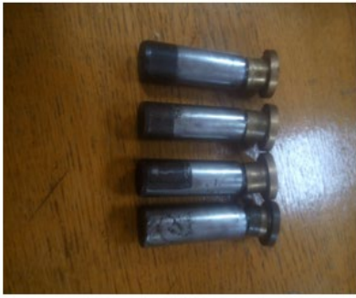
Корозійний знос плунжерів
