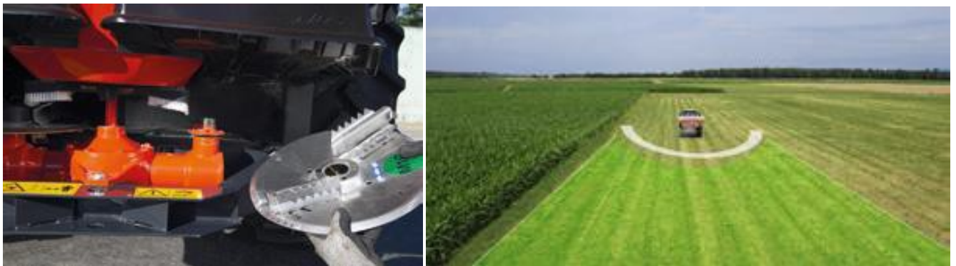
Рис. 1.5. Розкидні диски MDS (Multi-Disc-System)
