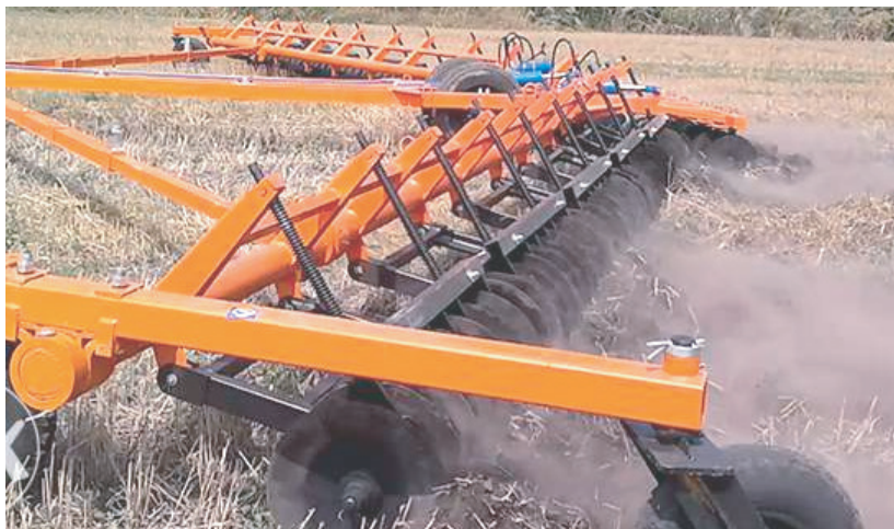
Рис. 1.13. Загальний вигляд луцильника на основі дводискових секцій: 1 – брус основної рами; 2 – проміжна рамка; 3 – секція
