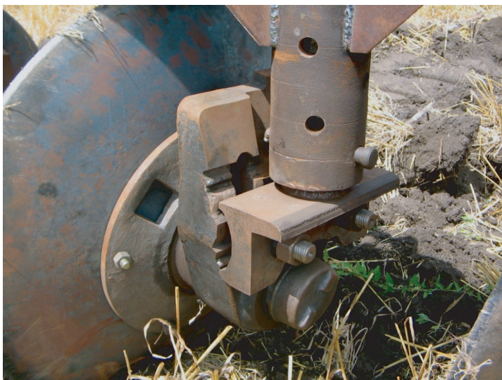
Рис. 1.34. Механізм регулювання кутів постановки диска: 1 – диск; 2 – за напрямком руху; 3 – до вертикалі
