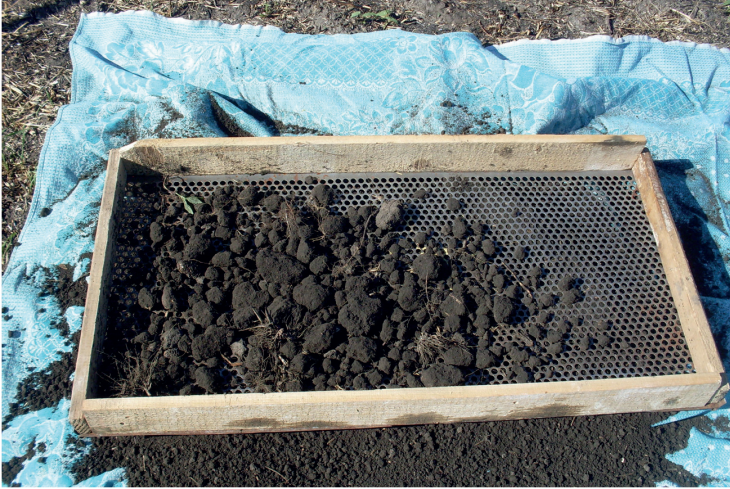
Рис. 4.8. Просіювання решетом взятої проби ґрунту
