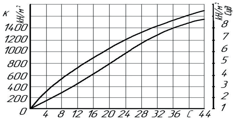
Рис. 4.5. Залежність питомого зчеплення часток (СУД) та межі несучої спроможності ( K' ) від кількості ударів щільноміра ДорНДІ
