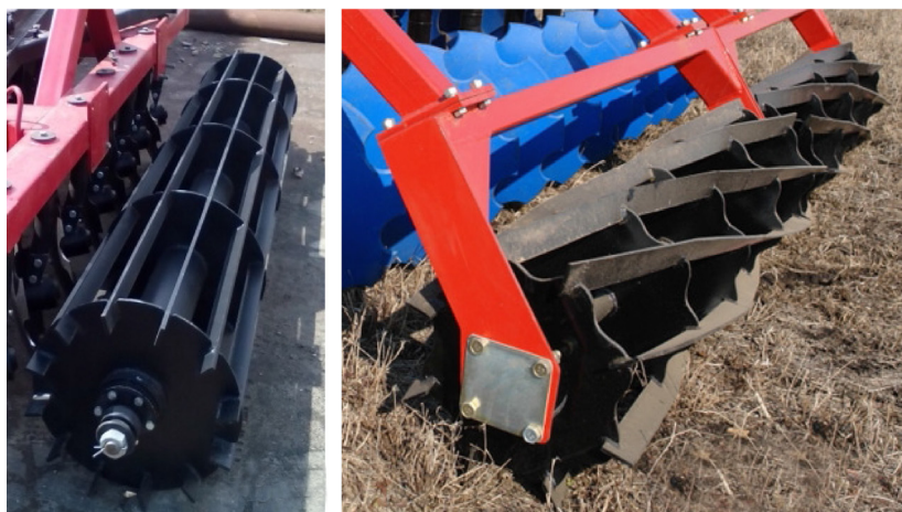
Рис. 1.31. Реберчасті котки дискаторів:
