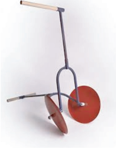
Рис. 1.40. Ручний дисковий підгортач
