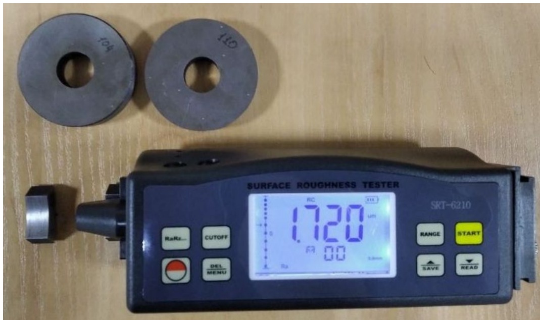
Рисунок 2.6 – Тестер шорсткості Walcom SRT-6210 із досліджуваними зразками
