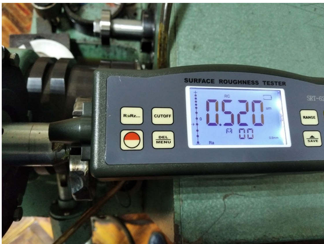
Рисунок 3.8 – Визначення шорсткості досліджуваних зразків на машині тертя без їх знімання
