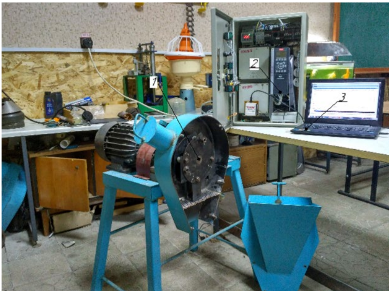
Рисунок 3.3 - Загальний вигляд експериментальної установки: 1 – експериментальна установка; 2 – частотний регулятор; 3 – ноутбук для отримання та розрахунку даних.
