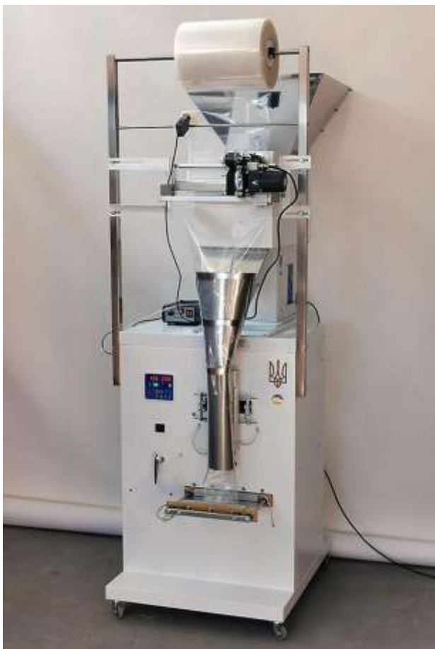
Рис. 3.2. Фасувально-пакувальний автомат моделі «N-1000»
