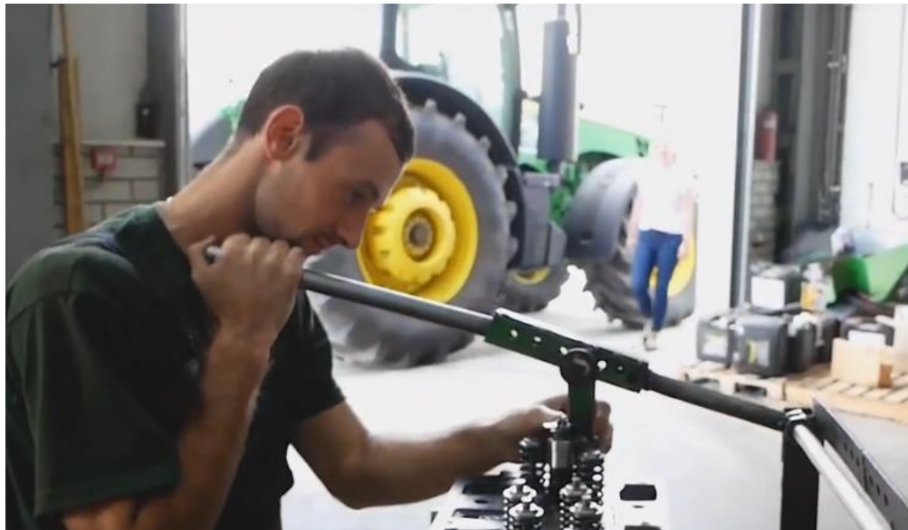
Рис. 1.17. Механічна обробка деталей та розсухарювання головки циліндрів
