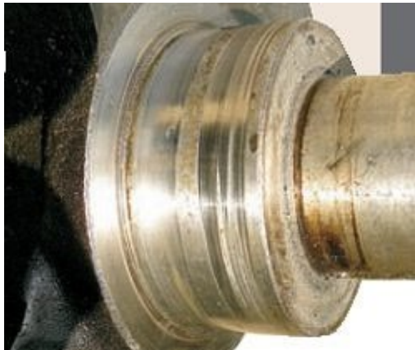
Рисунок 2.4 – Знос торцевих поверхонь
