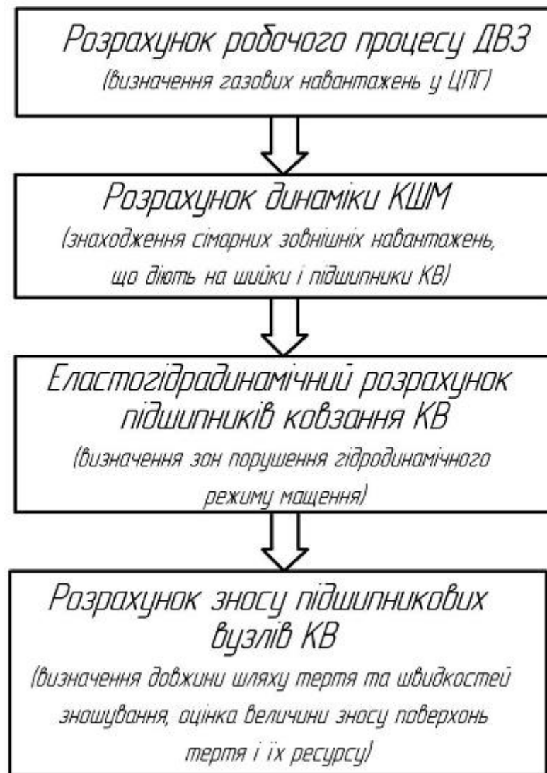
Рисунок 3.2 - Загальна принципова блок-схема побудови методики розрахункового прогнозування зношування підшипникових вузлів ДВЗ
