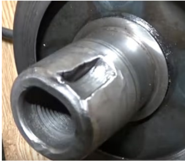
Рисунок 2.8 – Знос шпонкового пазу
