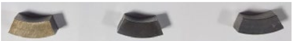
Рисунок 3.8 - Колодка для випробувань на машині тертя СМЦ-2
