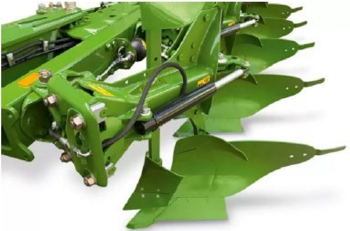
Рис. 1.13 – Запобіжна система плуга фірми Amazone.
