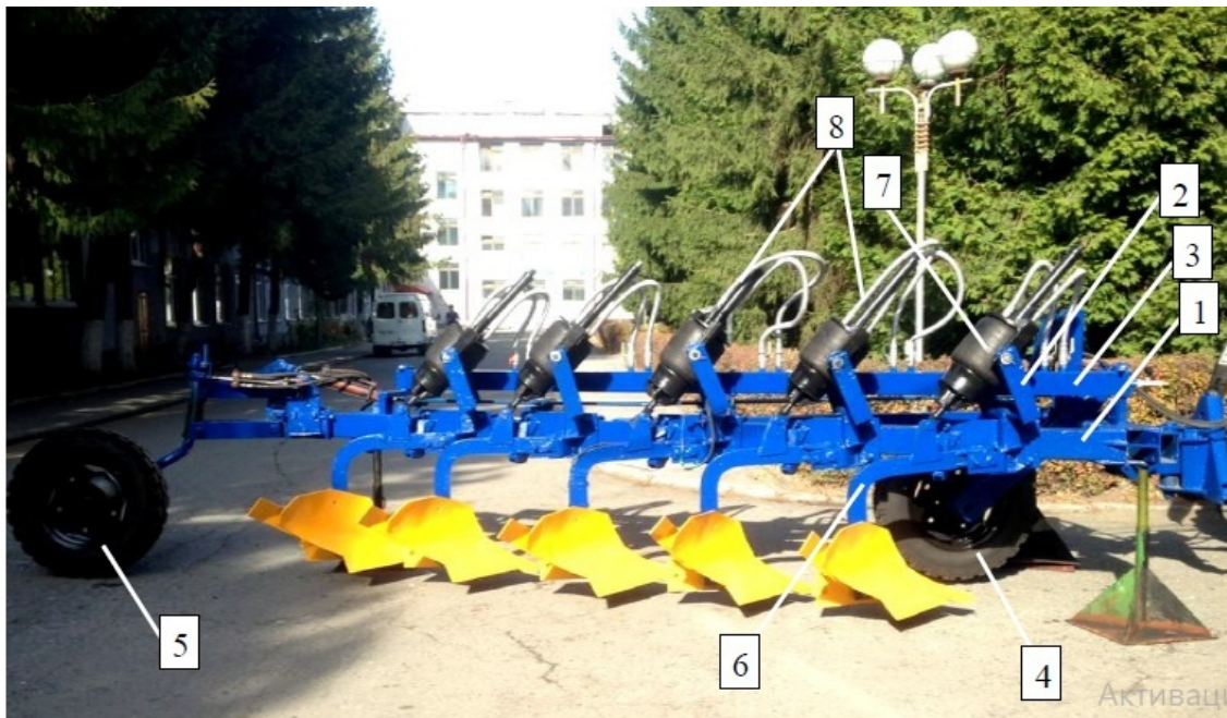
Рис. 5.1 – Плуг ППП-5-35: 1 – рама; 2 – кронштейн; 3 – резервна ємність; 4 – регульовальне колесо; 5 – опорне колесо; 6 – стійка секції; 7 – пневматичний запобіжник; 8 – трубопроводи.
