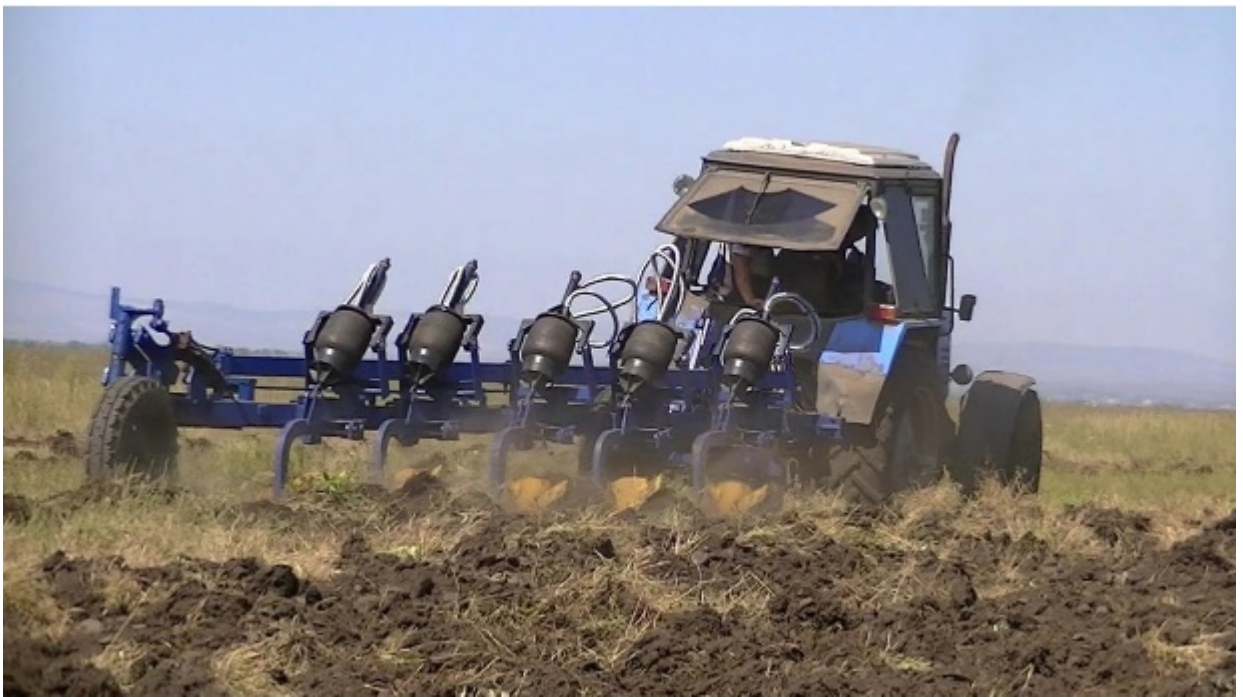
Рис. 5.2 – Випробування плуга ППП-5-35 з пневматичними запобіжниками в польових умовах.
