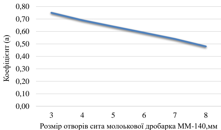
Рисунок 3.3 – Вплив розміру отворів сита молоткових дробарок ММ-140 на коефіцієнт вирівнювання подрібненої суміші зернової і гранульованої сировини
