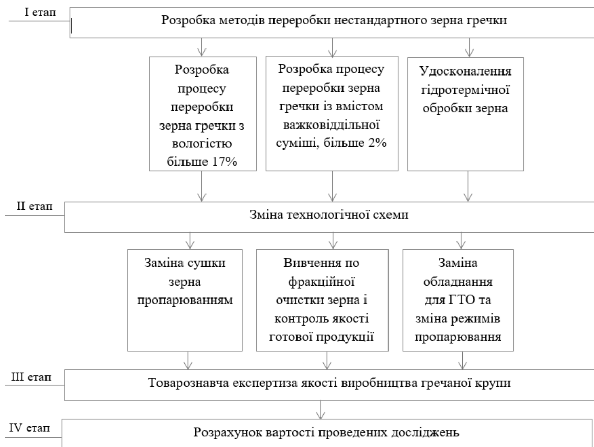
Рисунок 2.1 – Схема проведення дослідження з переробки некондиційного зерна гречки
