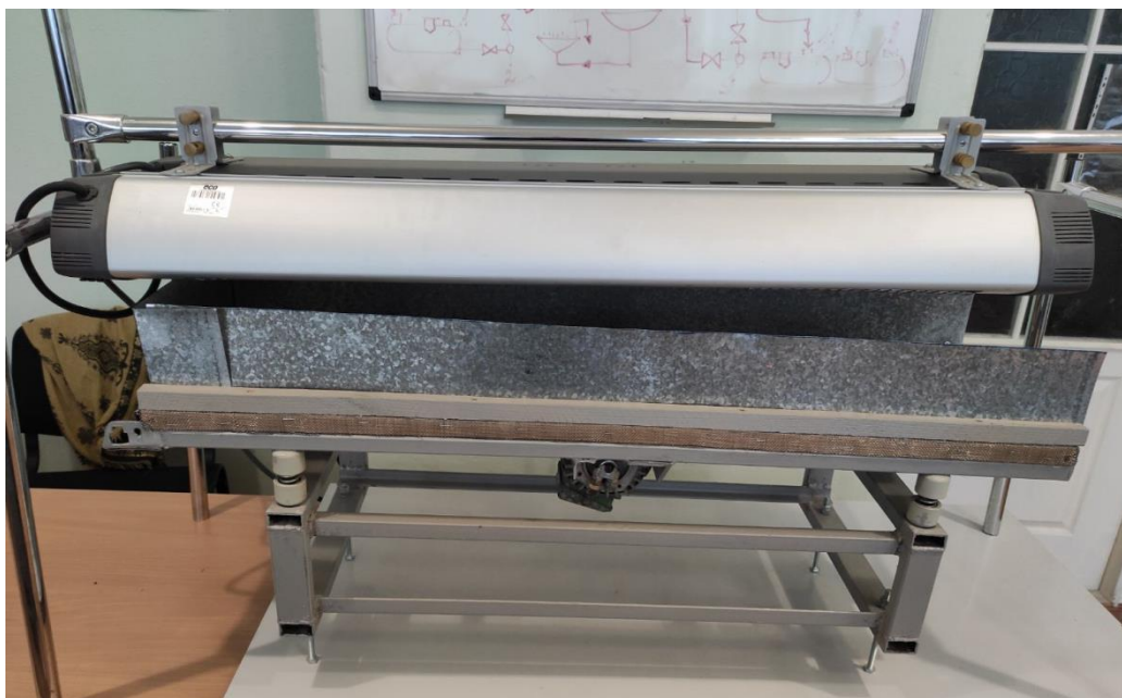
Рисунок 2.1 – Загальний вигляд дослідного устаткування для мікронізації зерна пшениці
