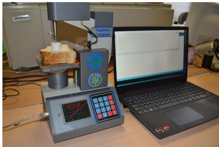
Рисунок 2.3 – Фото інформаційно-вимірювального комплексу для визначення реологічних характеристик харчових продуктів.
