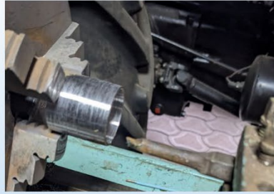
Рис. 5.2. Проточування металевої вставки
