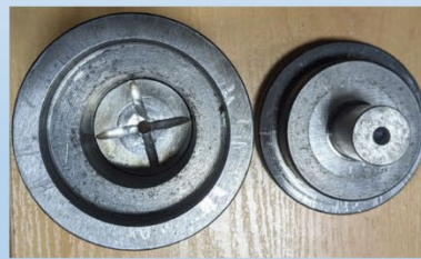
Рис. 5.5. Прес-форма для виготовлення втулки литтям під тисом
