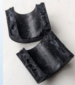
Рис. 6.2. Результати граничних навантажень для суцільної втулки без армування
