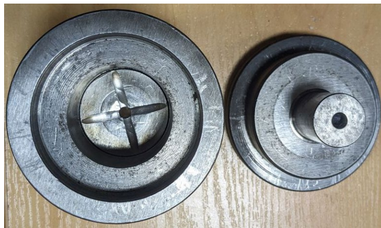
Рис.3.5. Прес форма для виготовлення втулки литтям під тиском Експериментальні випробування
