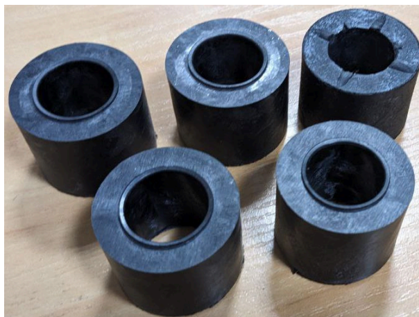
Рис. 3.6 Готові втулки з ПКМ з варіаціями внутрішніх вставок
