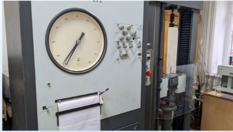
Рис. 6.1. Лабораторна прес-установка для проведення досліджень навантажень на виготовлені зразки втулок
