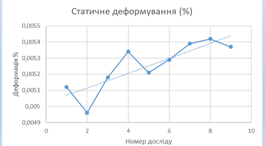
Рис. 7.2. Діаграма статичного деформування деталі відповідно до номеру досліджу
