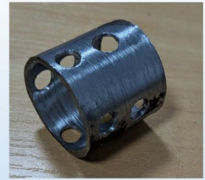
Рис. 5.3 Металева вставка з перфорованими отворами
