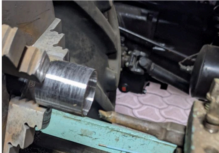
Рис. 3.2. Проточування металевої вставки на токарному верстаті
