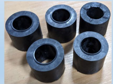
Рис. 5.6. Готові втулки з ПКМ з варіаціями внутрішніх вставок
