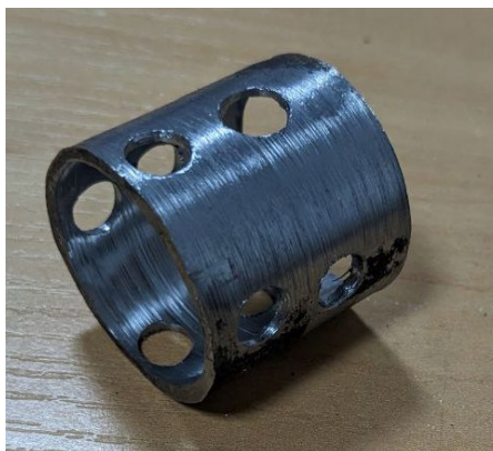
Рис. 3.3.Металева вставка з перфорованими отворами
