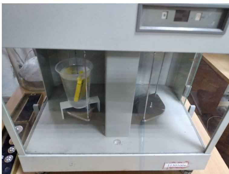
Рисунок 3.2 – Визначення маси зразку з матеріалу Elastan D100 зануреного у воду
