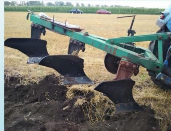
Рис. 8 – Плуг із встановленими відвалами з поліетилену PE-500 та PE-1000
