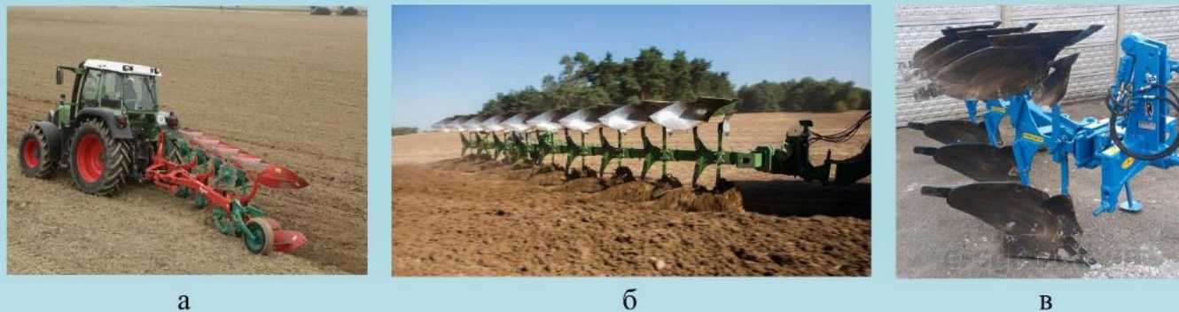
Рис. 6 – Плути з суцільними відвалами: а – Kverneland 150 B; б – John Deere 3810; в – Rabe Werk 100
