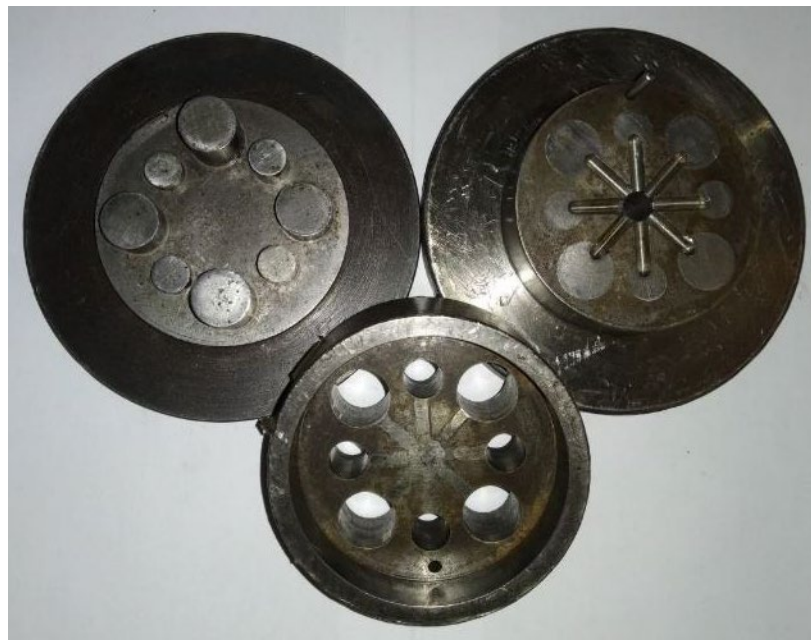
Рисунок 2.5 – Складові елементи прес-форми для виготовлення зразків на дослідження міцнісних та теплофізичних характеристик
