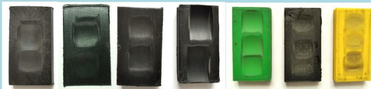
Рис. 19 – Загальний вид зразків після примусового абразивного зносу (зразки розташовані у порядку відповідно до табл. 3)
