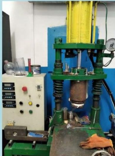
Рис. 13 – Машина для лиття ПКМ під тиском та прес-форми одержання експериментальних зразків
