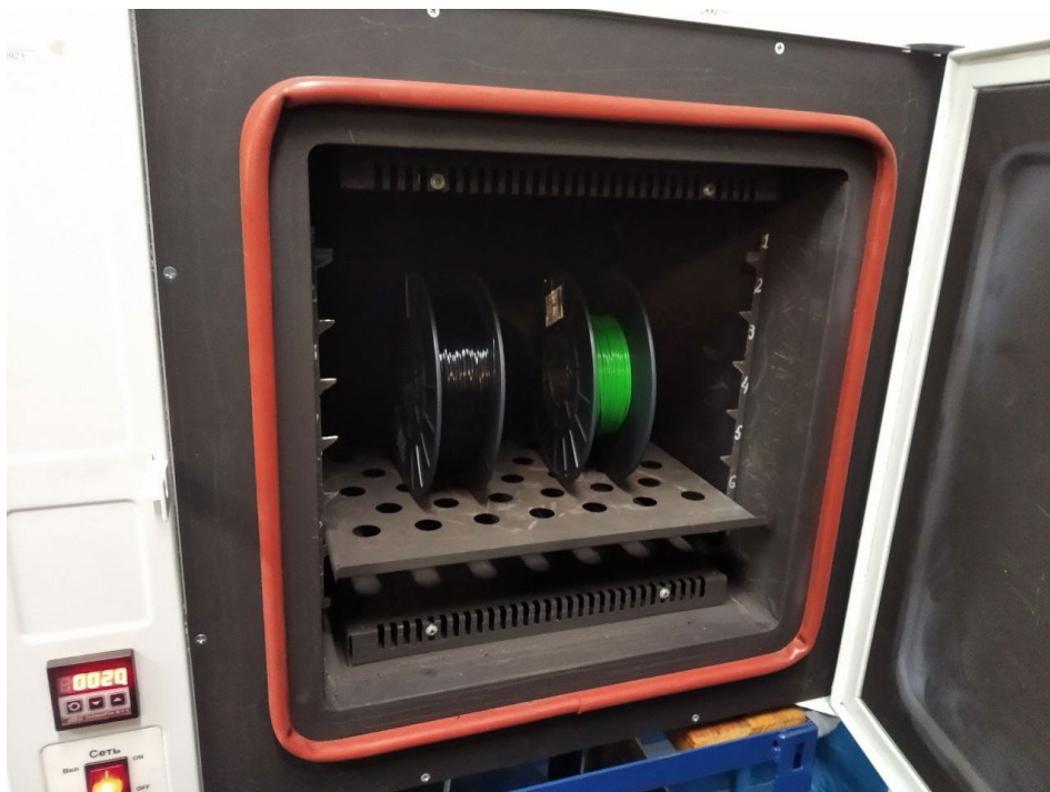
Рисунок 2.3 – Термошафа СНОЛ 67/350 із вихідними матеріалами ABS+ та PLA завантажені для сушіння
