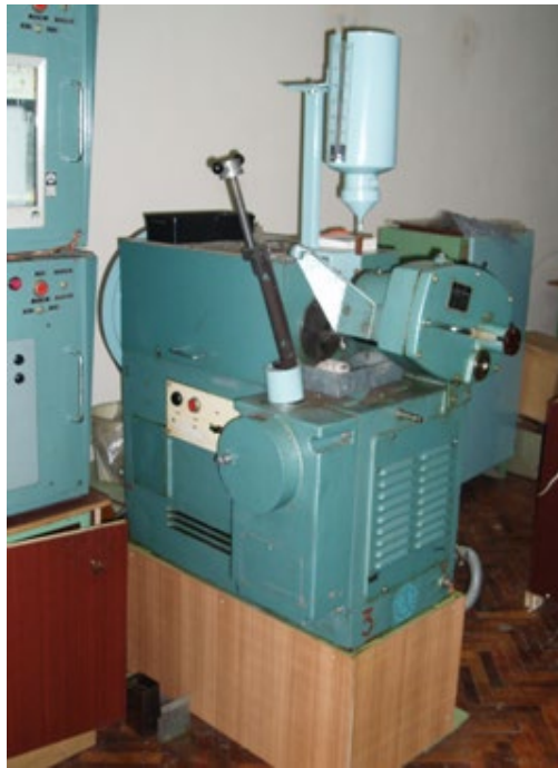
Рис. 2.12 – Машина СМЦ-2: а – з механізмом подачі стандартизованого абразивного матеріалу в зону тертя; б – схема елементів механізму подачі абразивного матеріалу та створення навантаження: 1 – диск із гумовим кільцем; 2 – стандартизований абразив (електрокорунд); 3 – механізм створення навантаження між зразком та гумовим диском; 4 – зразок із матеріалу, що досліджується
