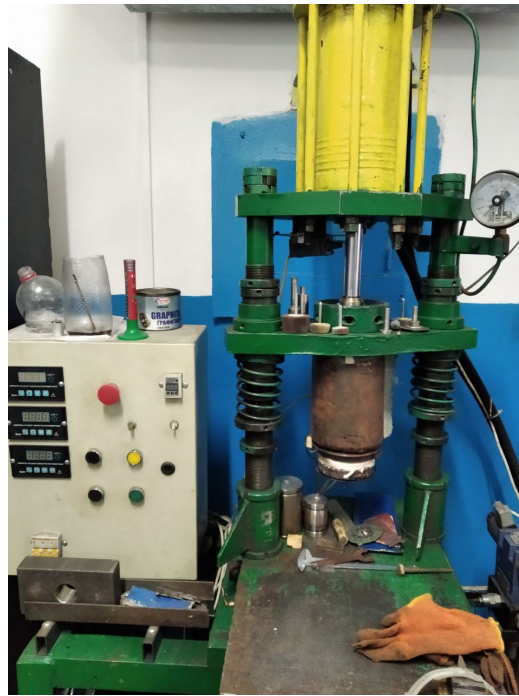
Рисунок 2.4 – Вертикальна машина типу шприц-прес для лиття пластиків під тиском
