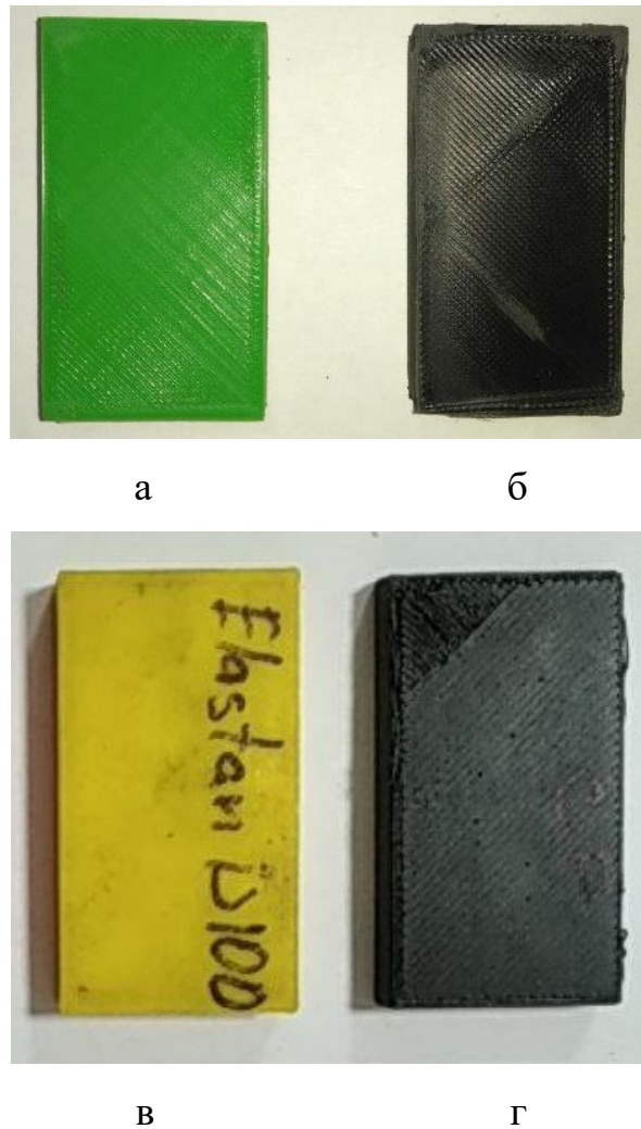
Рисунок 2.10 – Зразки для дослідження абразивної стійкості одержані методом 3D друку: а – PLA; б – ABS+; в – Elasthan D100 ; г – Nylon CCF.
