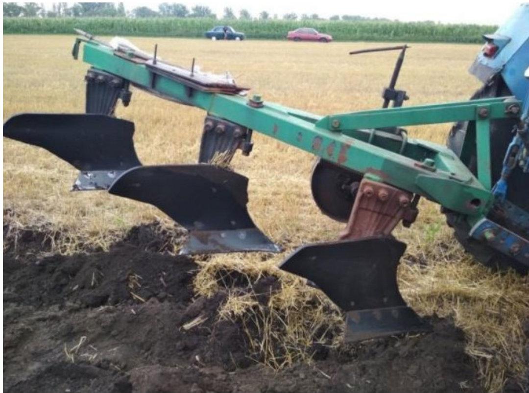
Рисунок 1.10 – Плуг із встановленими відвалами з поліетилену ПЕ-500 та ПЕ-1000 на польових випробуваннях (джерело [17])
