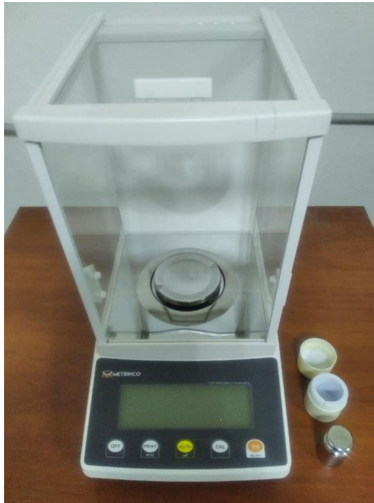
Рис. 2.13 – Аналітичні терези METRINCO AB224 з гирею для проведення калібрування
