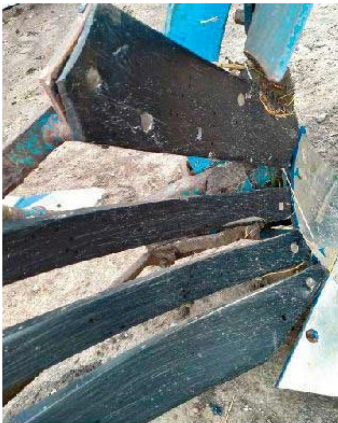
Рисунок 1.11 – Смуговий відвал плуга із накладками з композитного матеріалу
