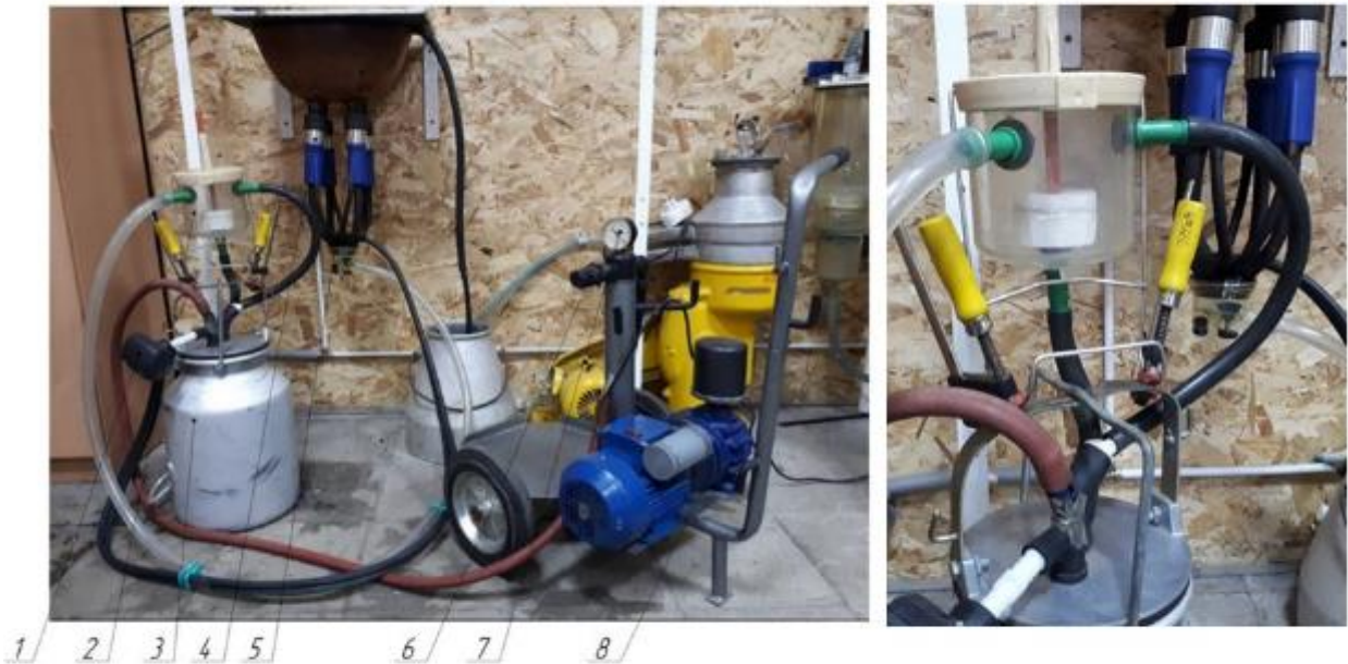
Рисунок 5 - Загальний вигляд експериментальної установки для дослідження адаптивного дойльного апарата: 1-пульсатор; 2- регулятор вакууму; 3-дойльне відро; 4- дойльний стакан; 5- «штучне вим'я»; 6 - вакуум регулятор; 7- вакуумметр; 8- вакуумний насос
