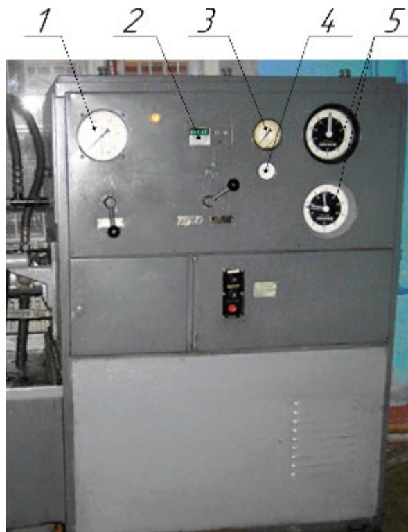
Рис.3.5 – Установка для випробування клапанно-золотникових пристроїв: 1- манометр контролю навантаження агрегатів; 2-прилад контролю кількості обертів приводного вала; 3- манометр контролю тиску в очисній магістралі; 4 – прилад контролю температури оливи; 4-прилади контролю витрат оливи
