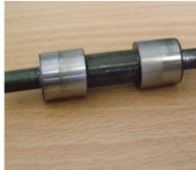
Золотник клапанної коробки (1 – сліди гідроабразивного зношення в спряженні «золотник – отвір корпусу»)
