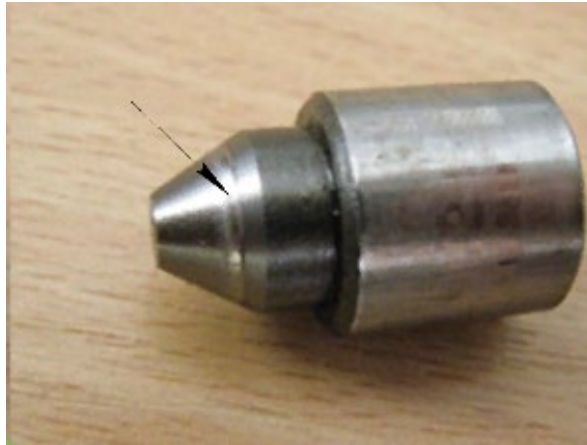
Рис. 4.1 – Знос ущільнюючої поверхні клапана
