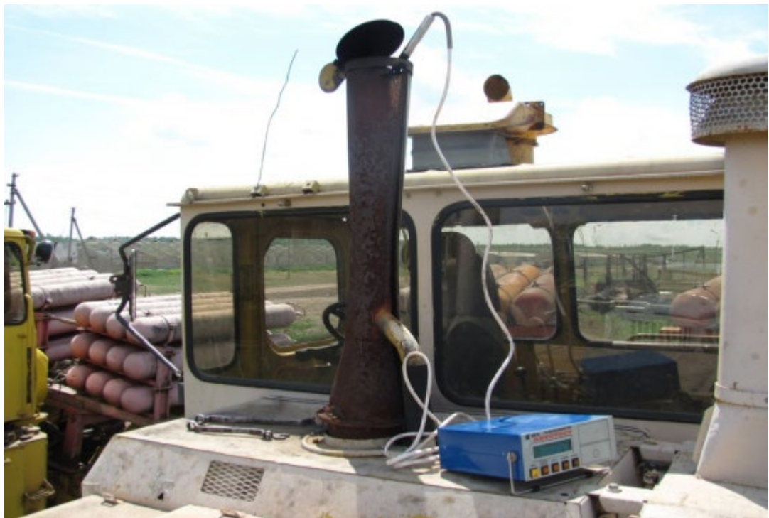
Рисунок 3.8 – Дослідження екологічних показників при роботі МТА в режимі дизеля та газодизеля
