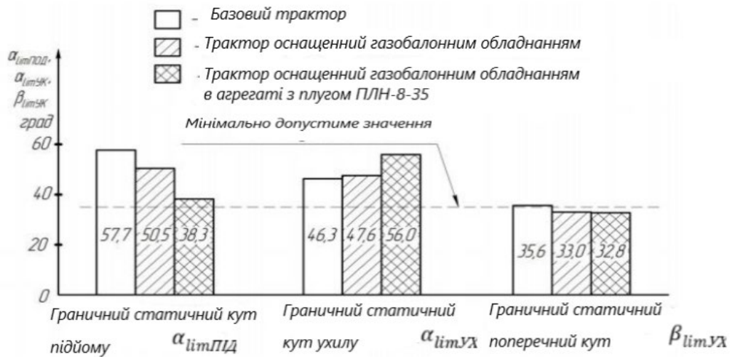
Рисунок 2.14 – Граничні статичні кути перекидання трактора
