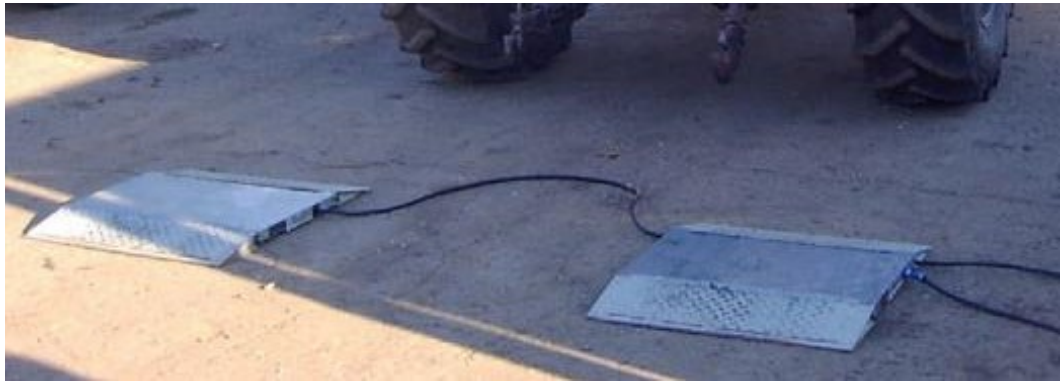
Рисунок 2.5 – Електронні транспортні ваги ВАПО-10
